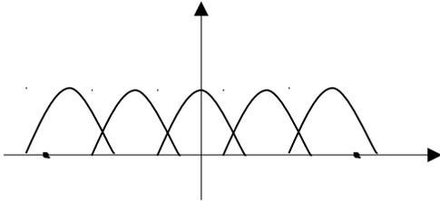
E la sua ricostruzione tramite il filtro visto prima sarebbe impossibile. La sovrapposizione delle armoniche prende il nome di aliasing. Segue il teorema di Shannon: Sia  $f_s$  la frequenza in corrispondenza della quale si ha la banda limitata, allora il periodo di campionamento deve essere  $\frac{1}{2f_s}$ , questo significa che la  $\omega_s$  deve essere almeno il doppio della banda del segnale.
