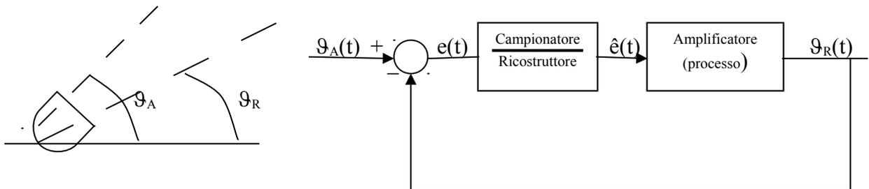
Il radar trasmette ogni  $T$  secondi. Ci chiediamo quanto vale  $e(t) = \vartheta_A - \vartheta_R$  quando  $t \neq kT$  (con  $k$  numero intero). L'obiettivo del controllo è ovviamente quello di far tendere  $e(t)$  a zero. All'uscita del campionatore avrò un treno di impulsi
